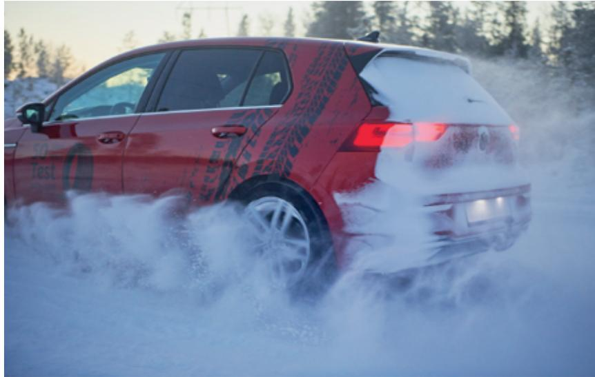
Performance 3, s'est arrêté en 31,7 mètres. En revanche, le même véhicule équipé du moins bon pneu, le Syron Everest 2, a nécessité 47,1 mètres, soit un écart de 15,4 mètres pour le même véhicule lancé à la même vitesse.
