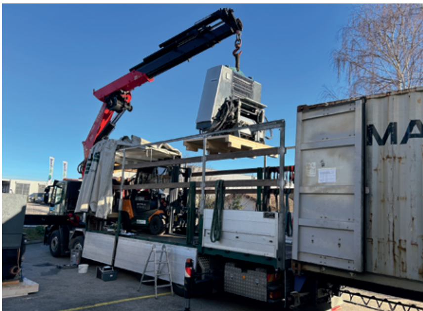
Chargement de l'un des éléments de l'ancienne presse: 4,8 tonnes!
